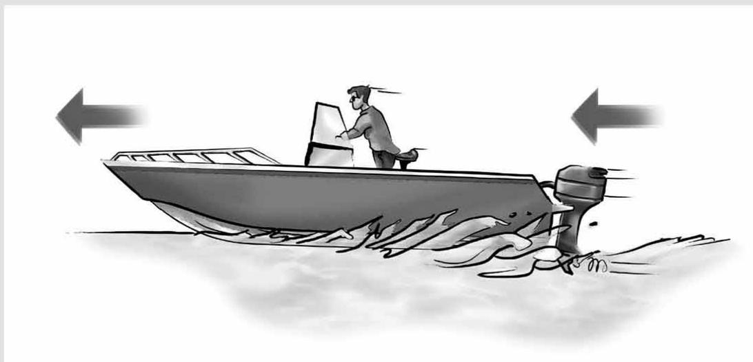
**Наилучшая посадка.** Хороший способ найти наилучшую посадку судна – провести контрольный проход по спокойной воде при малой нагрузке и максимальной скорости. Его следует проводить на открытой акватории, свободной от других судов. Вы определите наилучшую посадку судна относительно горизонтальной плоскости по пониженному брызгообразованию как в носу так и за кормой.
