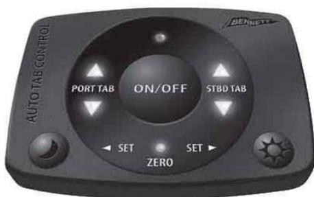
А) Индикаторная панель – она позволяет включать и выключать автоматику, а также фиксировать точку наилучшей ходовой посадки корпуса судна. Световые индикаторы на ней будут мигать при работе приводов транцевых плит.
