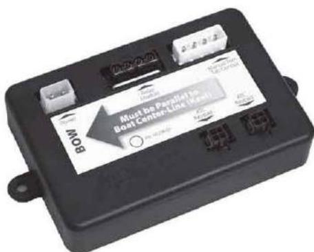
В) Управляющий модуль – это сложный электронный процессор, совмещенный с датчиком посадки судна. Он обрабатывает сигналы датчика, сохраняет в памяти наилучшую посадку судна при «обучении» («нулевая точка») и стремится поддерживать ее за счет работы транцевых плит. Важно: управляющий модуль должен монтироваться правильно, иначе он не будет работать как надо.
